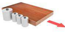
10. 2-х моторная обкатка углов (ROUND)
